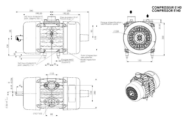
KIT MOTEUR HYDRAULIQUE E140 HYDRAULIC MOTOR KIT E140
