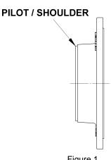
Figure 1 PUMP HEAD - SIDE VIEW
